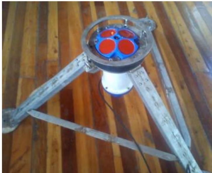
Figura 4.2-32: Perfilador de corrientes acústico Teledyne WorkHorse Sentinel 600 junto a su trípode de acero para anclaje, Instalado en la campaña de invierno 2018
