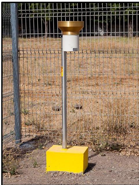
**Fig. 5: Pluviómetro Estación Meteorológica 10m.**
