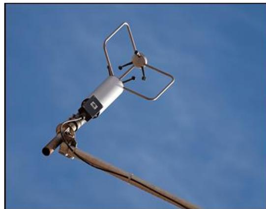
**Fig. 3: Torre DASA. Anemómetro ultrasónico.**
