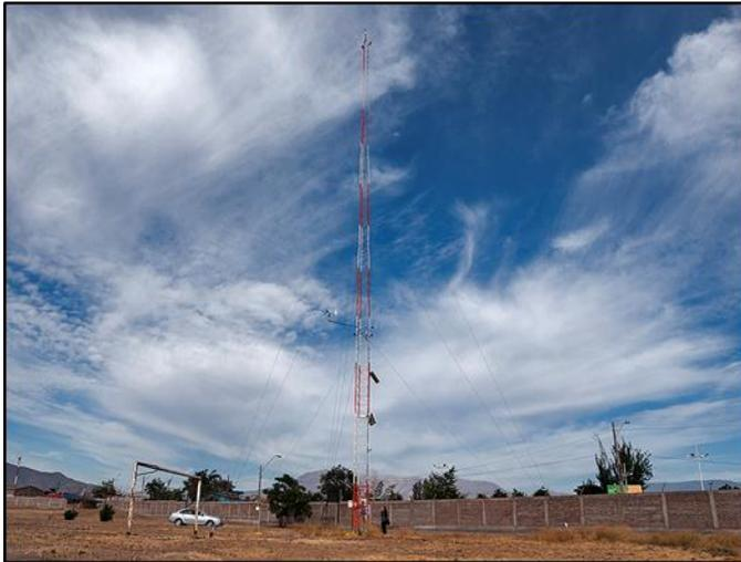
**Fig. 1: Torre DASA – Pudahuel. Estación meteorológica 30 m con anemómetros ultrasónicos.**
