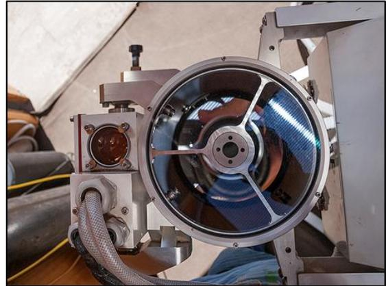
**Fig. 8: Equipo LIDAR. Vista superior del emisor de pulsos láser y del telescopio newtoniano integrado en el equipo.**
