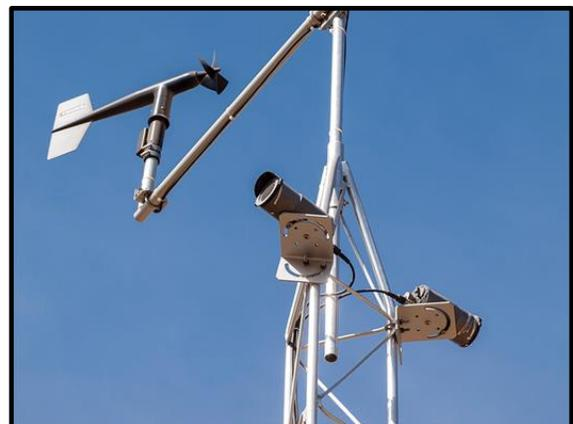
**Fig. 6: Anemómetro, veleta y Cámaras de observación Estación Meteorológica 10m.**
