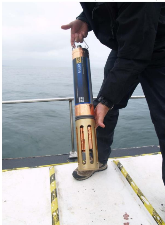
Sonda YSI 6600-V2 (lista para instalar)
