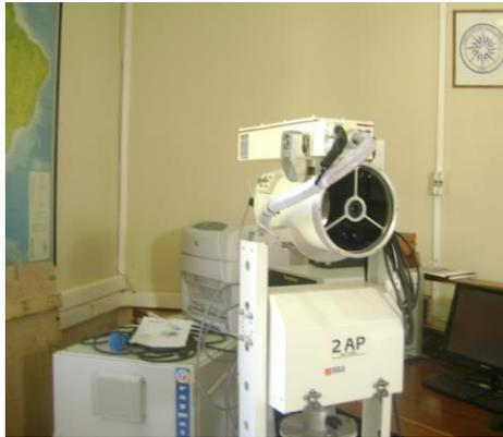
Equipo LIDAR (Light Detection And Ranging) en el Centro Nacional de Análisis de la DMC.
