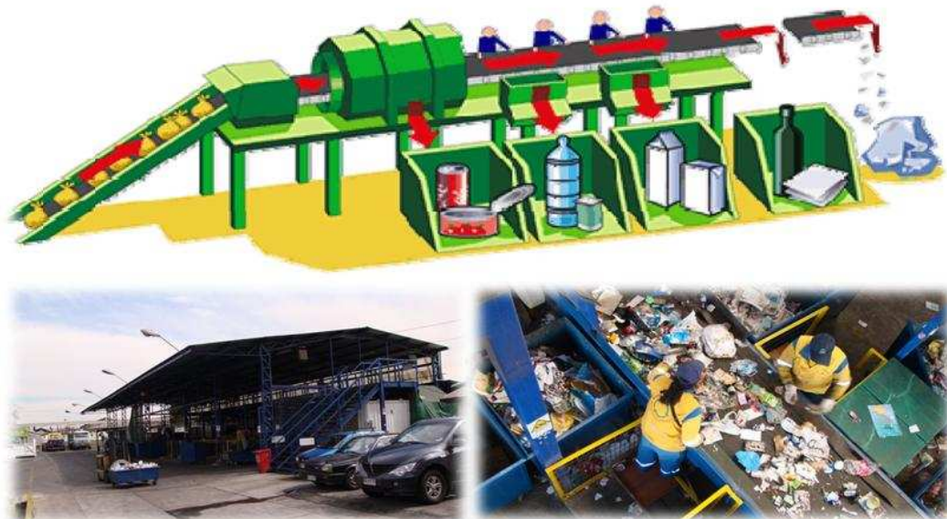
Figura 4-4 Funcionamiento de una Planta de Clasificación Manual
