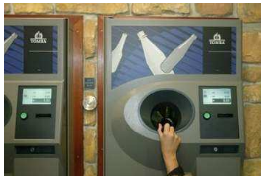
Figura 3-21 Sistema de devolución envases plásticos (bebidas) y botellas de cerveza – devolución de depósito automático
